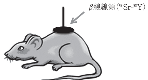
Fig. 1. マウスの照射方法. ICR雌マウス(CRJ:ICR)の背部を剃毛後, 皮膚に密着して照射を行った。照射用線源は ^{90}\text{Sr} - ^{90}\text{Y} の円盤形線源(直径2 cm, 線量率は2.28-1.79 Gy/min, \beta 線エネルギー: 2.24 MeV)を用いた。
